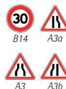
– La signalisation de position décrite précédemment peut être utile pour améliorer la lisibilité et la visibilité de l'aménagement si nécessaire, mais n'est pas à systématiser. L'absence de panneaux B15 et C18 de part et d'autre de l'aménagement permet aux usagers d'auto-réguler entre eux le franchissement de l'écluse, ce qui permet de garantir globalement une modération des vitesses équilibrée entre les deux sens de circulation.
