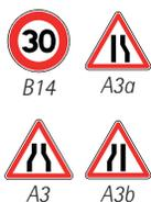
– En présignalisation, le panneau B14 limitant la vitesse à 30 km/h est généralement associé avec les panneaux A3, A3a ou A3b selon que le rétrécissement est symétrique ou bien s'opère à partir de l'un des côtés.
